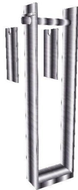
Abb. 8: Auflagerschaukel, beim Einbau der Träger und in der Planung
